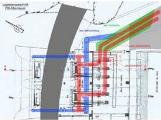
_Abgreifen (rot) der bestehenden (blau) Seewasserentnahmestellen
